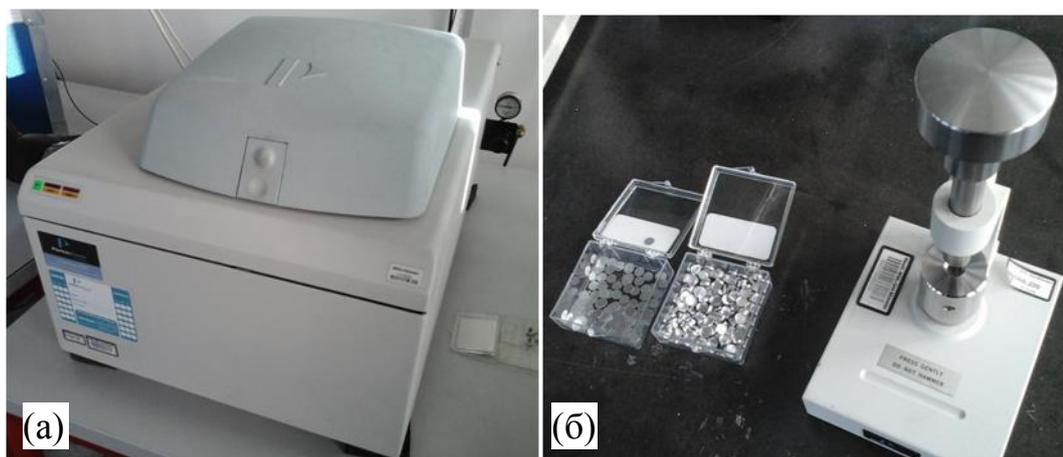
Рисунок 2.5 – Дифференциальный сканирующий калориметр "Diamond DSC", Perkin Elmer (а) и устройство запрессовки образцов для калориметрических измерений (б)
