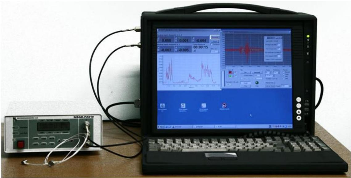
Рисунок 2.17 – Акустико-Эмиссионная система «ЭЯ-2» в комплекте с предусилителем MSAE-FA010.
