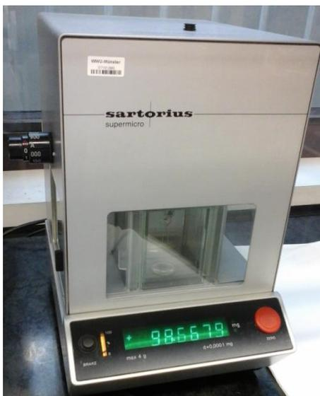
Рисунок 2.1 – Лабораторные весы Sartoris supermicro
